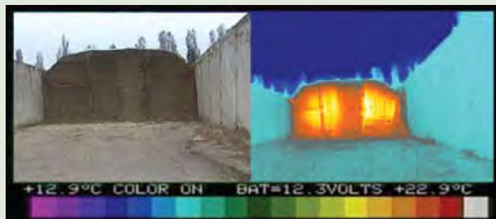
Fotografie silážnej jamy vyhotovené termovíziou jasne ukazujú na prítomnosť procesov spôsobujúcich zahrievanie neošetrených siláže.
